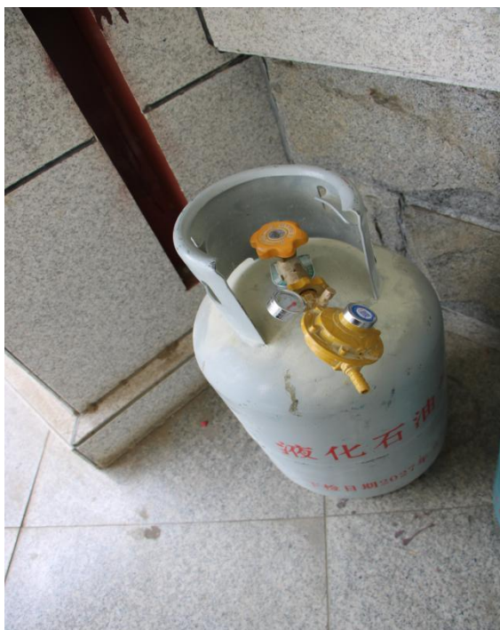
图 1-8 117 栋 1 单元 301 室厨房使用的液化石油气瓶轰燃后现场照片
